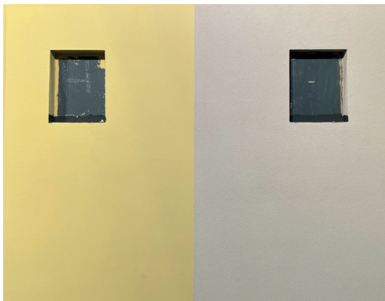
Immagini dei sistemi di ripristino webertherm renovETICS dopo i cicli di invecchiamento
