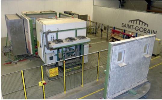
Immagini dell'impianto per l'invecchiamento delle pareti di prova
