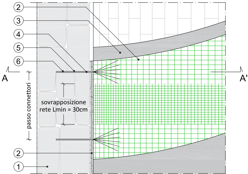
PLANIMETRIA CONNESSIONE SISTEMA
