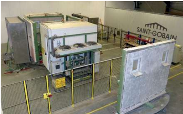
Immagine dell'impianto per l'invecchiamento delle pareti di prova
